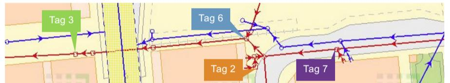
▲ 通過監控污水井硫化氫濃度的變化規律，可知道周邊建築物的污水排放情況及用水習慣
